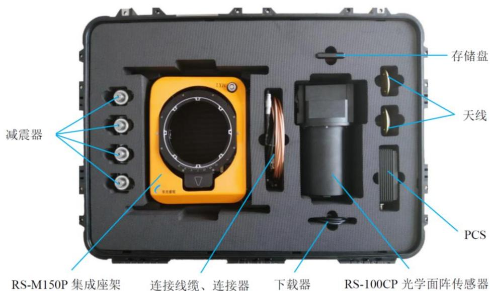
图 2 轻型大面阵航摄系统设备包装
